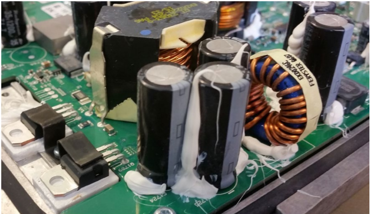
LIMNING AV STÖRRE KOMPONENTER FÖR BÄTTRE HÅLLFASTHET VID MEKANISKA PÅFRESTNINGAR. KÄLLA: EK POWER SOLUTIONS
