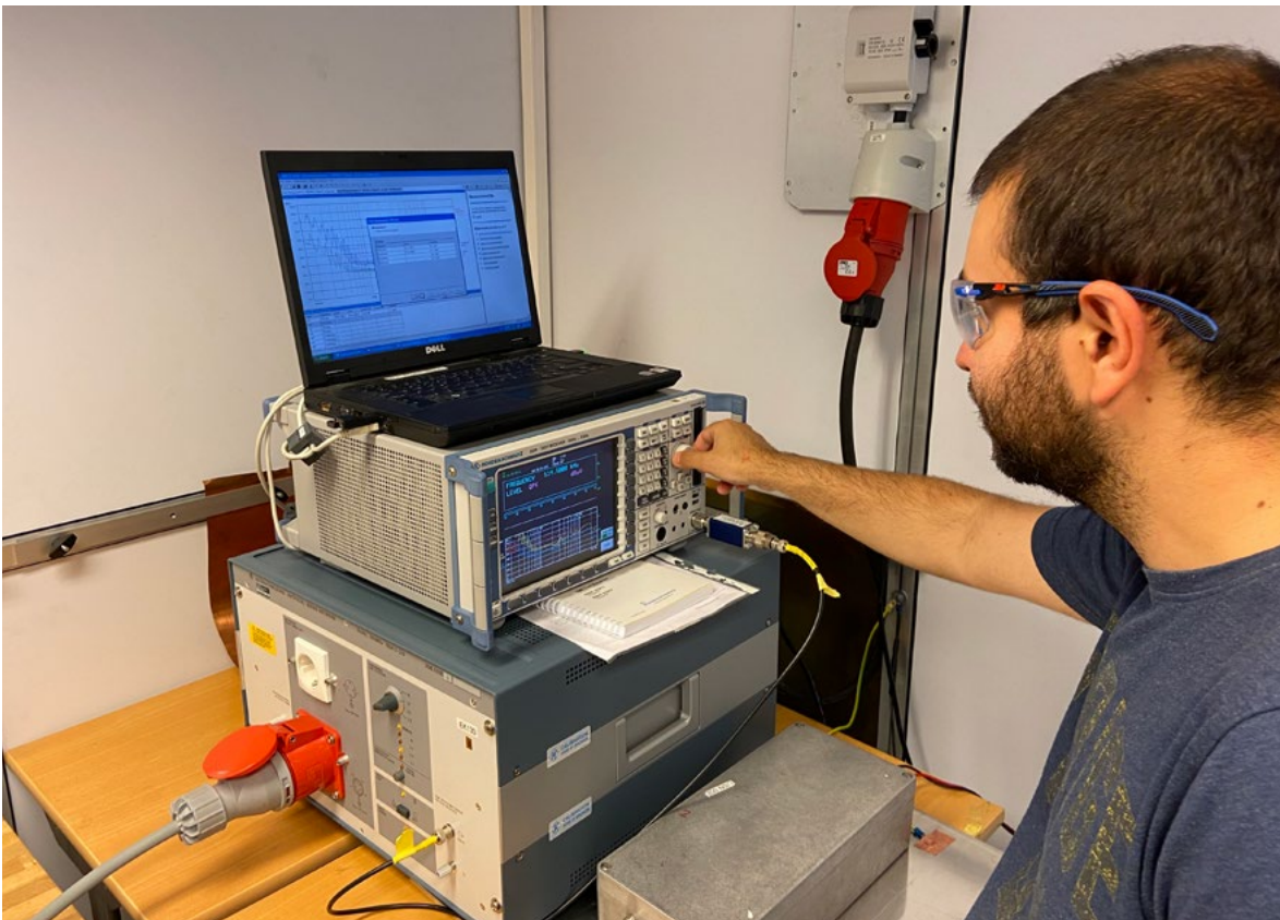
MÄTNING AV LEDNINGSBUNDNA EMISSIONER HOS EK POWER SOLUTIONS. KÄLLA: POWER SOLUTIONS
